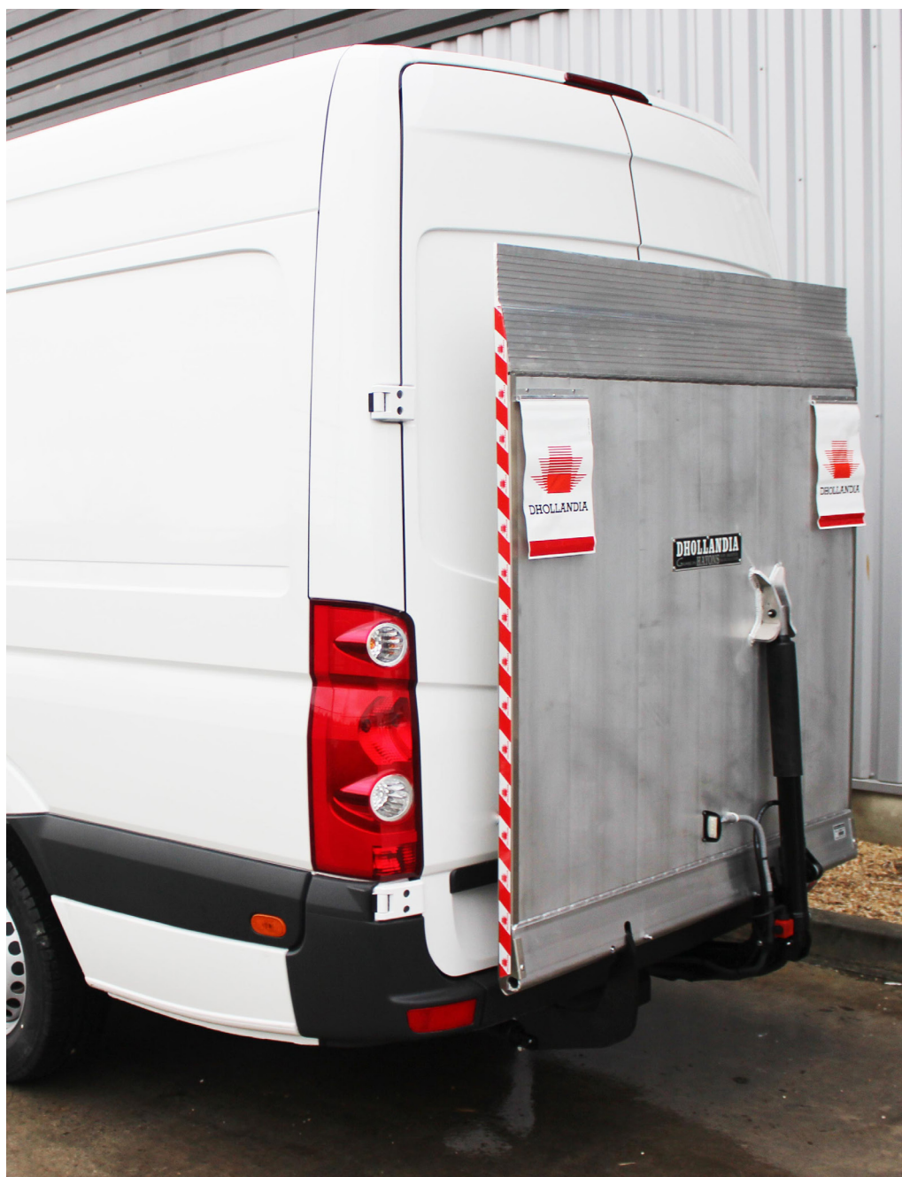
Hayon 500 kg DHP avec plateforme de 1550 mm et arrêt de rolls
