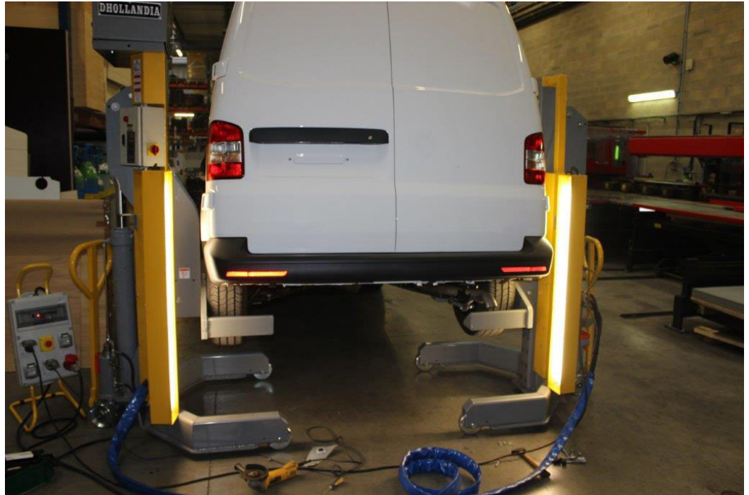
Zone dédiée et outillage spécifique destiné au montage des hayons élévateurs DHOLLANDIA.
