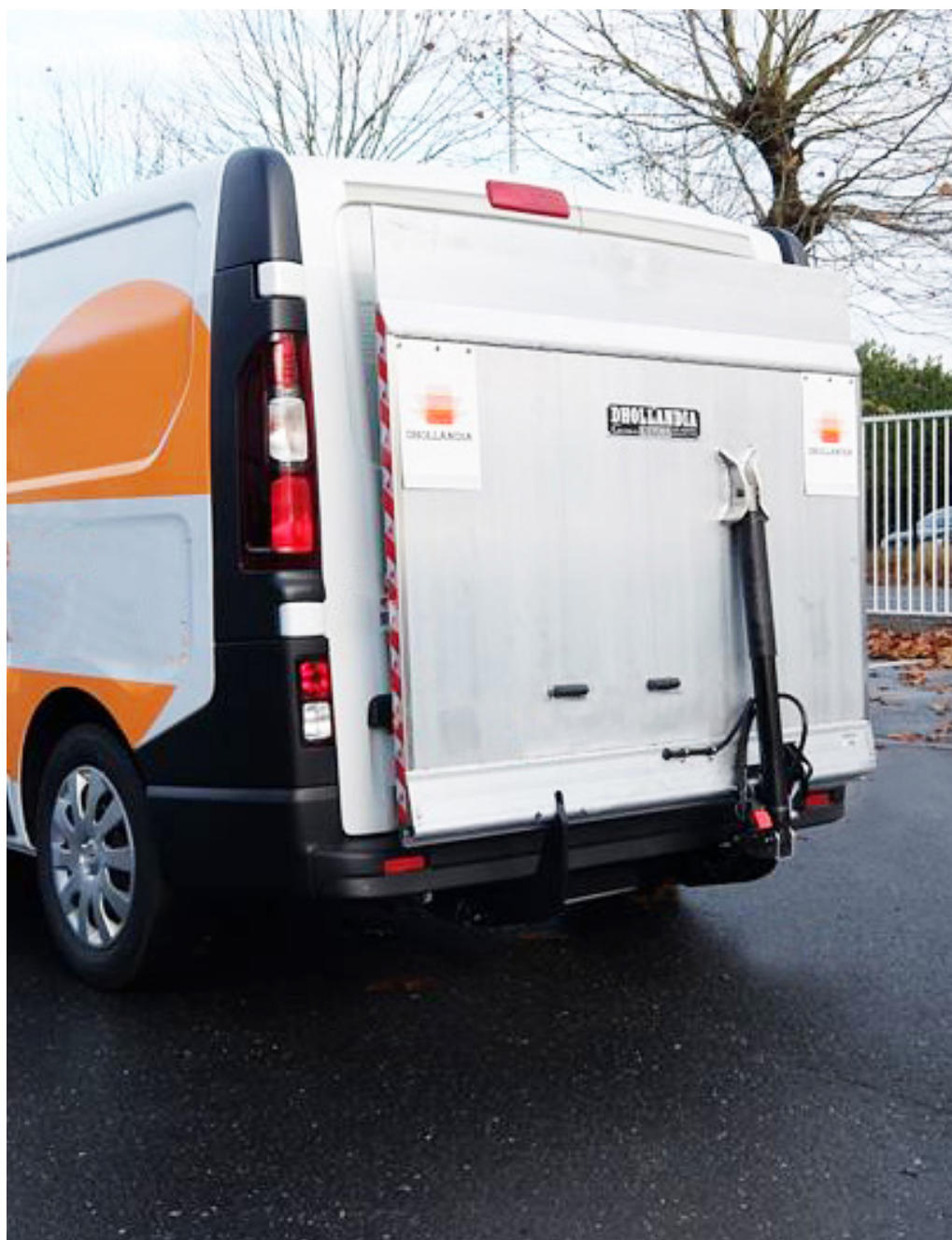
Hayon 500 kg DHLP avec plateforme de 1550 mm et arrêt de rolls
